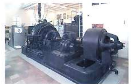
De zender van SAQ, geen elektronica maar werktuigbouwkunde. Vermogen: 200 kW; frequentie: 17,2 kHz; toerental: 2115 t/m; omlaopsnelheid rotor: 638 km/h (!); aantal polen: 976.
